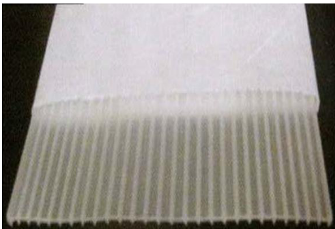
Công nghệ bắc thấm đứng được đề tài đề xuất cho việc xử lý nền móng bãi chôn lấp tại Củ Chi.
