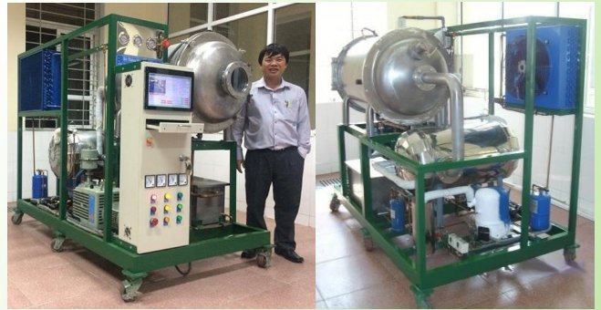
Hình: Hệ thống sấy thăng hoa DS-6 (phiên bản thứ 6)
