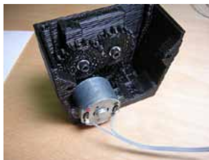
Cấu trúc bên trong của robot di động đơn giản bao gồm: bánh xe, motor và dây nguồn điện. Nguồn: Nick Ames/Flickr.
