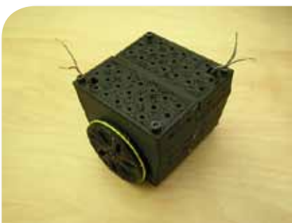
Cấu tạo bên ngoài của một con robot di động đơn giản chỉ bao gồm: bánh xe và bộ khung. Nguồn: Nick Ames/Flickr.
