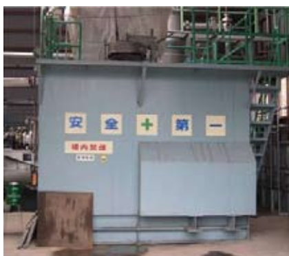
Thiết bị xử lý thủy nhiệt chuyên dùng để xử lý rác thải y tế tại Hokkaido, Nhật.
