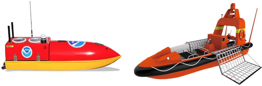
Hình 14: Phương tiện tàu tự hành dành cho việc cứu nạn, cứu hộ trên mặt nước
