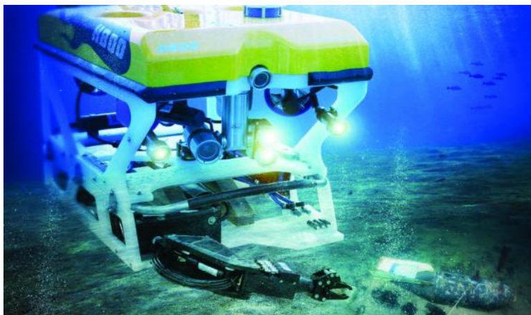
Hình 20: ROV trong công tác tìm kiếm và rà phá mìn, làm sạch đáy biển
