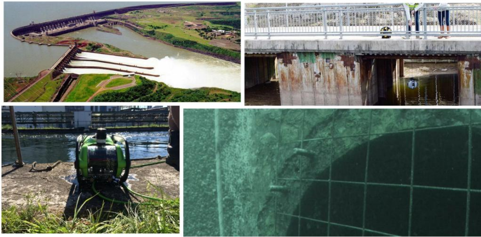
Hình 23: Kiểm tra hệ thống đập thủy điện dùng ROV- DTG2 tại Canada
