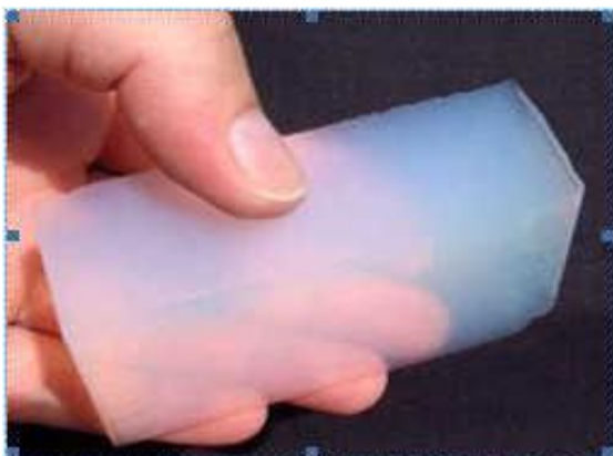
Hình 16: Vật liệu aerogel cách âm và nhiệt Hình 17: Tro trắng thành aerogel dạng bột
