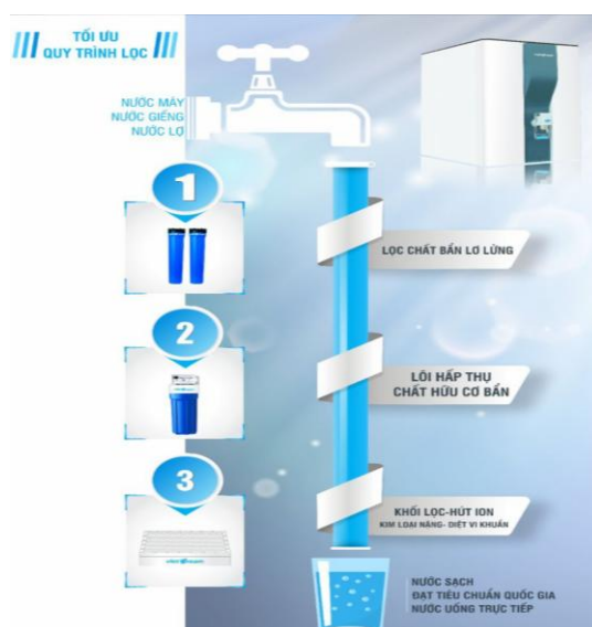
Hình 3: Quy trình lọc nước CDI trong xử lý nước
