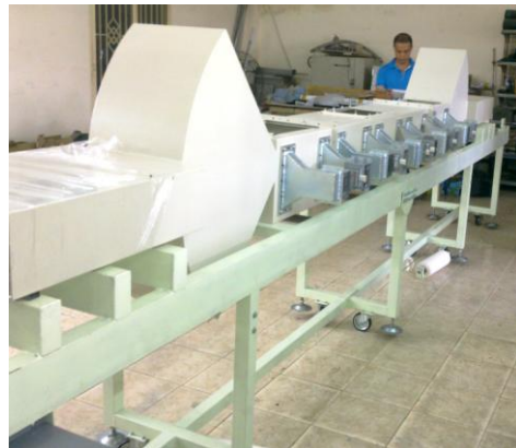
Hình 41: Lắp đặt các bộ dẫn sóng + antenna lên buồng phản ứng
