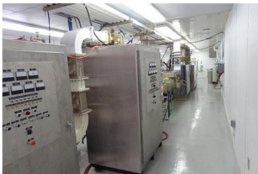
Hình 5: Hệ thống tiệt trùng bằng microwave cho suất ăn sẵn của WSU
