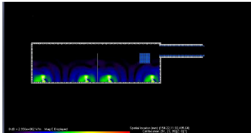
Hình 29: Kết quả Pha 1- mô phỏng sự phân bố vi sóng trong buồng phản ứng với 2 magnetron gắn trong 1 khoang.
