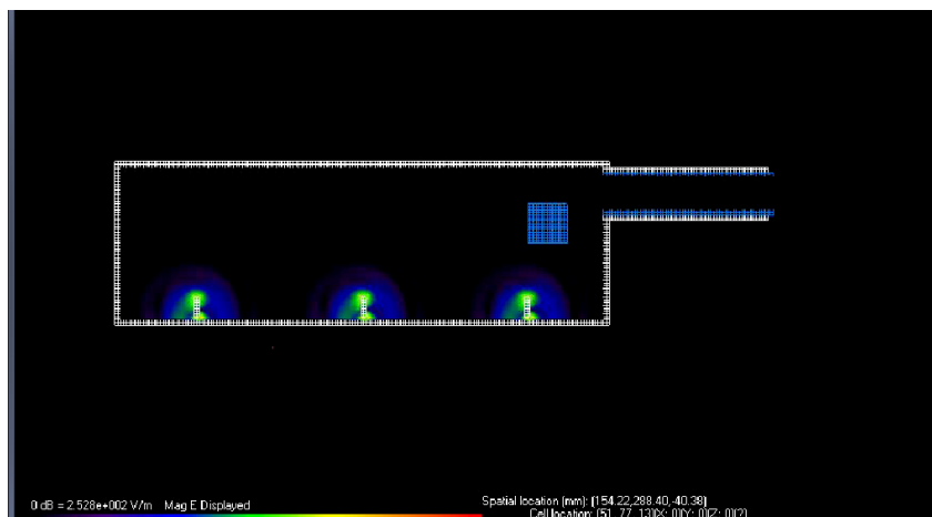
Hình 26: Kết quả Pha 2- mô phỏng sự phân bố vi sóng trong buồng phản ứng với 1 magnetron gắn ở giữa buồng
