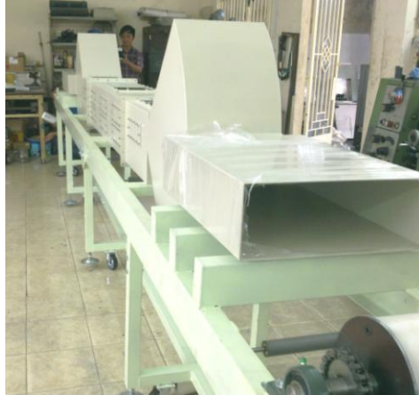
Hình 40: Lắp đặt bộ chống rò rỉ + buồng phản ứng trên băng tải
