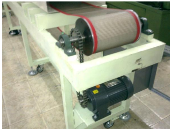
Hình 43: Lắp đặt hệ dẫn động băng tải và băng tải bằng teflon Lắp đặt thiết bị điều khiển (Hình 44 và 45)
