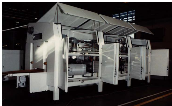
Hình 2: Hệ thống sấy bánh bằng siêu cao tần của Công ty APV Baker (Anh).
