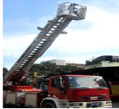
Hình 4: Xe thang loại 32 và 52 m để phục vụ công tác PCCC tại TP.Hồ Chí Minh
