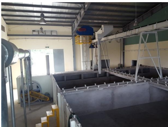
Hình 7: Máy sấy lúa giống 40 tấn/mẻ và dây chuyền chế biến 2,5 tấn/giờ
