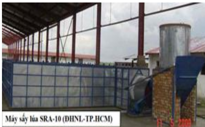
Hình 9: Máy sấy lúa SRA-10 kiểu lắp ghép ở Tanzania (Châu Phi)
