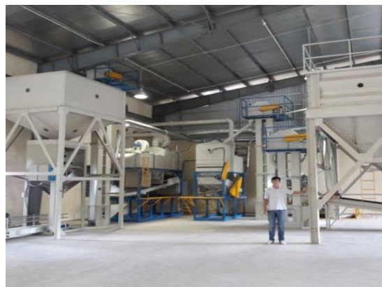
Hình 7: Máy sấy lúa giống 40 tấn/mẻ và dây chuyền chế biến 2,5 tấn/giờ
