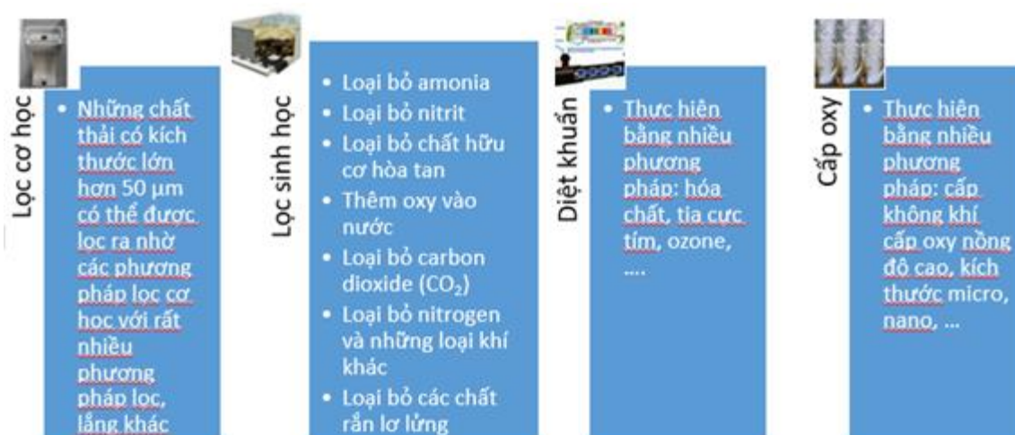
Hình 3: Bốn quá trình chính của hệ thống RAS.
