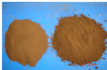
Đất đỏ có bổ sung AMS - 1 trước (trái) và sau (phải) thí nghiệm
