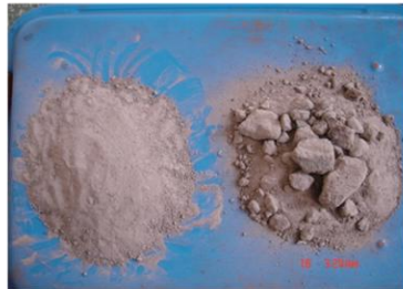
Đất xám không bổ sung AMS – 1 trước (trái) và sau (phải) thí nghiệm
