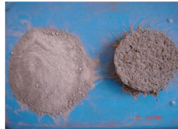
Đất xám có bổ sung AMS - 1 trước (trái) và sau (phải) thí nghiệm
