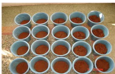
Thí nghiệm khả năng giữ nước theo thời gian trên đất đỏ
