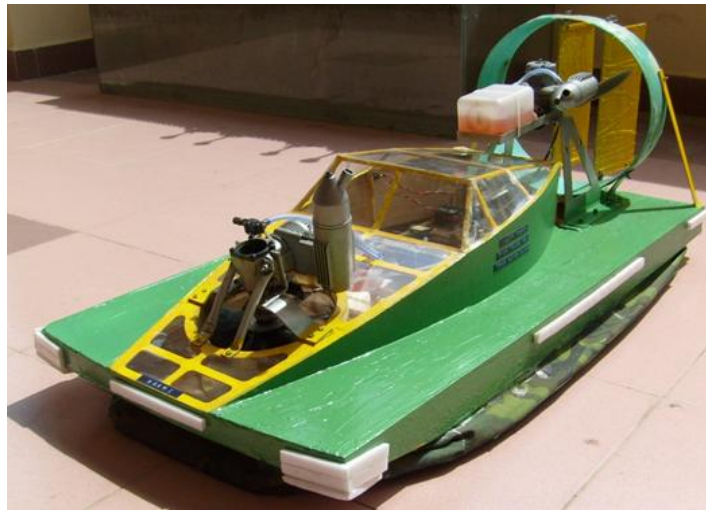
Hình 1.12 - Mô hình tàu đệm khí tỉ lệ 1/5 chế tạo tại Đại học Bách Khoa Tp.HCM.
