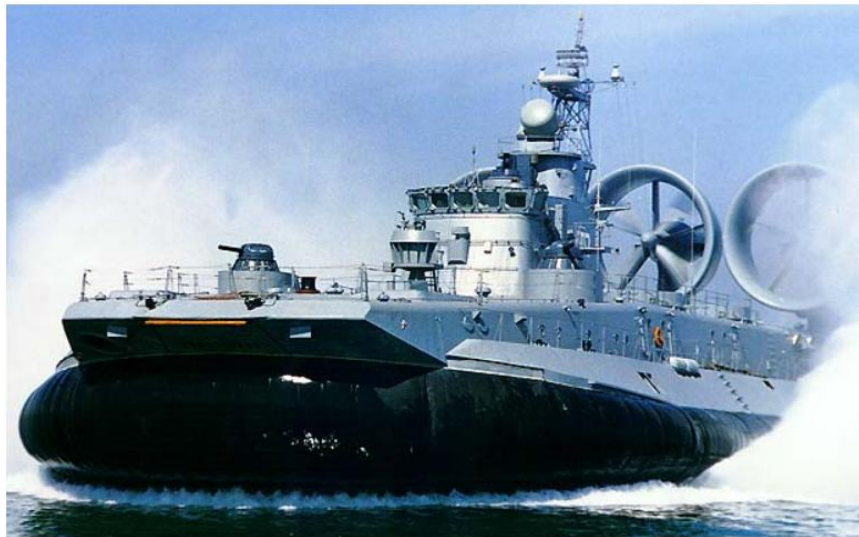
Hình 1.9: Tàu đệm khí quân sự Zurb của Nga với lượng chiếm nước gần 500 tấn.
