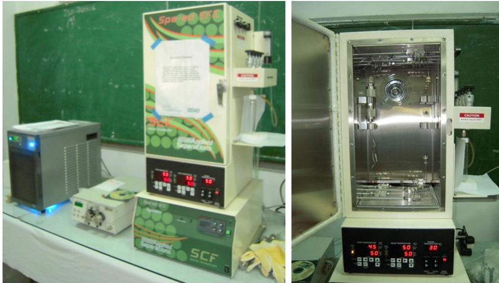
Hình: Thiết bị trích ly bằng CO 2 siêu tới hạn ở quy mô phòng thí nghiệm
