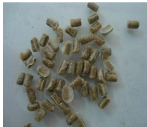
Hình 26: NPK được bọc polymer PSHH
