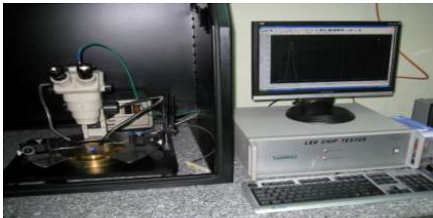
Hình 57: Hệ LED chip Tester ELT 1000 (Ecopia) – tại LNT
