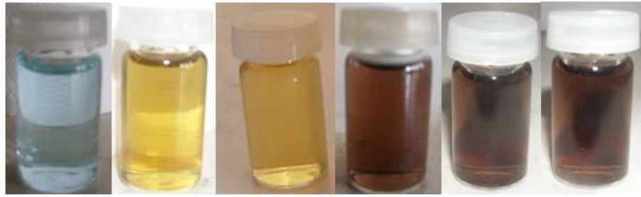
Hình 6: Quy trình tổng hợp và sự thay đổi màu sắc dung dịch đồng nano bằng cách khử \text{NaBH}_4
