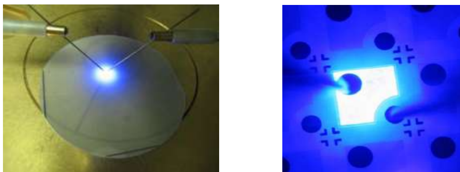
Hình 58: Hình ảnh chip LED phát sáng khi cấp dòng 20 mA
