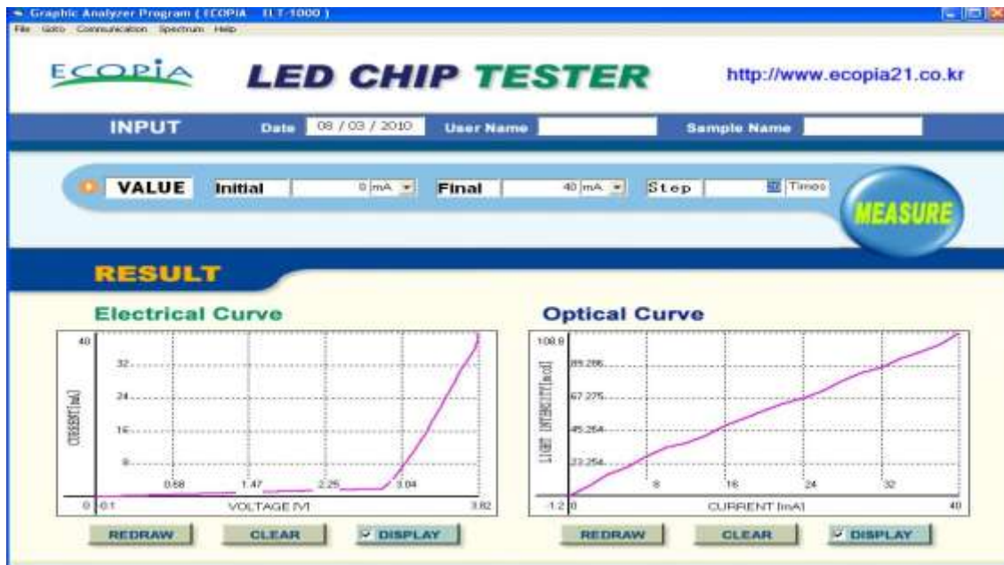
Hình 61: Đặc tuyến I-V (hình trái) và đặc tuyến quang-điện (hình phải) của chip LED
