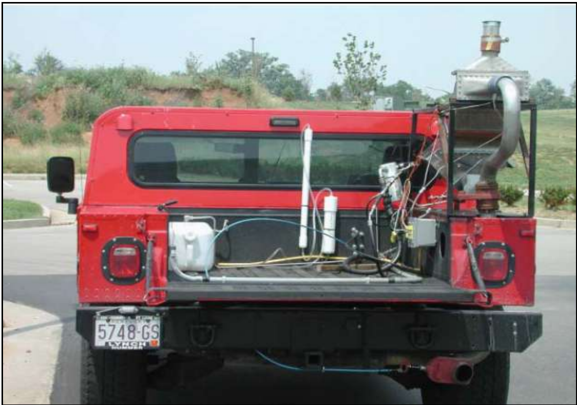
Hình ảnh một hệ thống thu hồi nước từ khói thải của động cơ đốt trong
