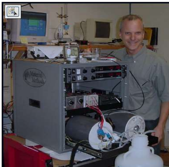
Hình ảnh hệ thống sản xuất nước ngọt từ nước biển bằng phương pháp điện dung
