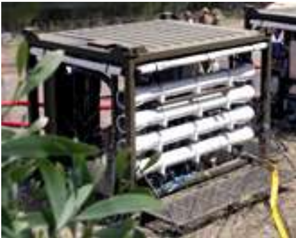
Thiết bị lọc nước cơ động model WTS30
