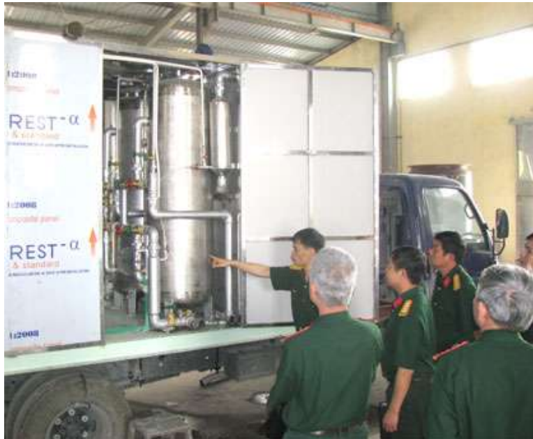
Hệ thống xử lý nước cấp cơ động do viện Công nghệ mới nghiên cứu, chế tạo [Báo QĐND điện tử - 28/10/2011]
