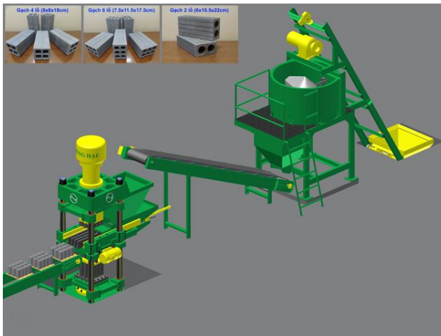
Hình 1: Sơ đồ thiết bị sản xuất gạch ống - xi măng cốt liệu, có lỗ rỗng suốt của CT. Trung Hậu.
