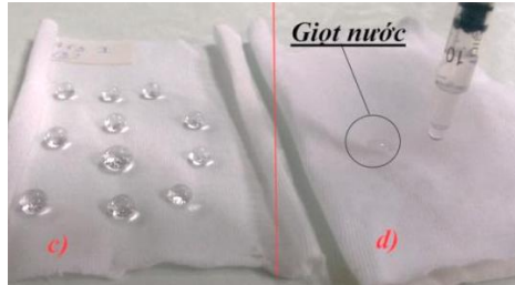
Hình – Vải được xử lý và phủ nano bằng công nghệ (bên trái) và vải không được xử lý (bên phải)
