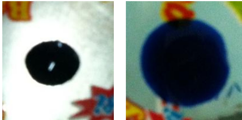
Hình– Độ hấp thụ bề mặt nhựa PP trước (trái) và sau khi xử lý bằng Plasma (phải)
