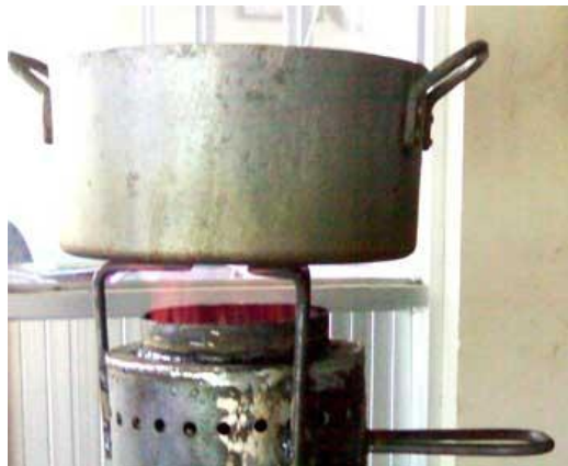
Hình 6. Bếp đốt khí hóa trấu thử nghiệm của Trung tâm R&D Tech Đại học Công nghiệp TP HCM công bố 8-2008
