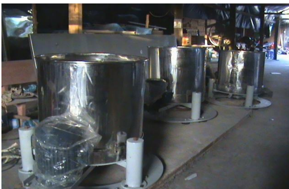
Hình: Máy tách nước, làm khô của Phân viện Cơ điện Nông nghiệp và Công nghệ sau thu hoạch chuẩn bị xuất xưởng
