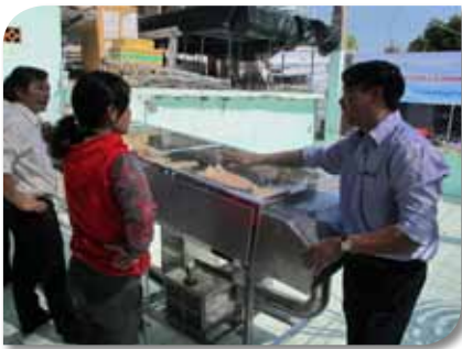
Ứng dụng máy sấy năng lượng mặt trời vào sấy thủy hải sản (cá dứa).
