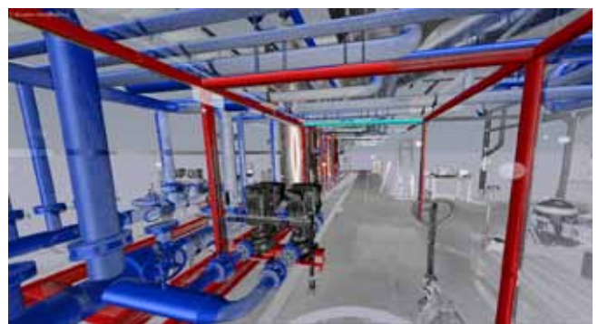
Hình 3: Thiết kế bổ sung thiết bị cho cơ sở hạ tầng dầu khí, được thực hiện và tối ưu hoá hoàn toàn trên mô hình đám mây điểm 3D do máy quét laser 3D cung cấp.
